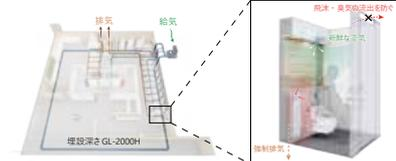
感染症対策とし、感染リスクの高い個室内へ新鮮な空気を供給。また、強制換気を行い、ブース外へ飛沫の流出を防ぐ。
